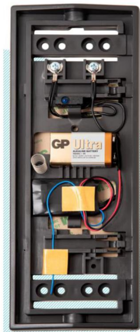
Batterioplacering på albue betjent kaldestationen.
